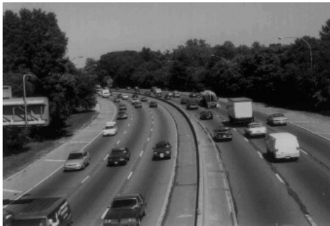
Figura 43 - Condizioni di circolazione LdS D
