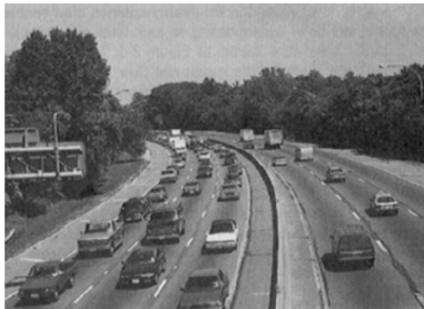
Figura 45 - Condizioni di circolazione LdS F
